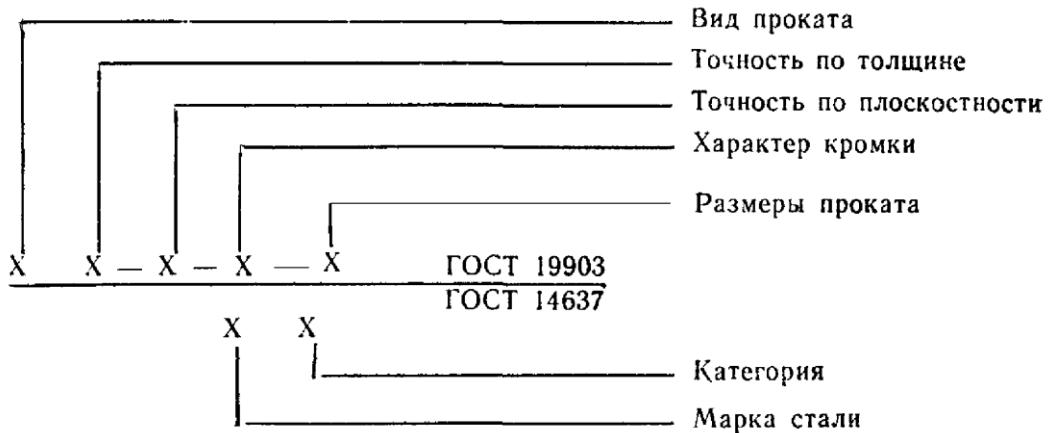
**П р и м е ч а н и е .** Параметры и характеристики проката, приведенные в схеме, если они не указаны в заказе, устанавливаются изготовителем и в обозначении не приводятся.
